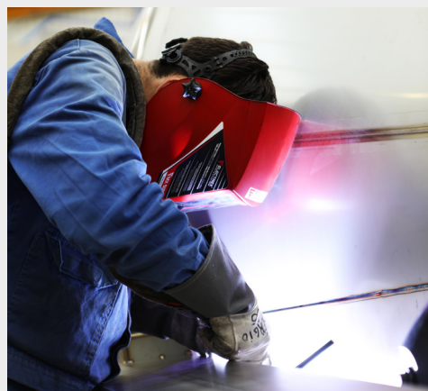
▸ Soudage TIG avec amorçage de l'arc par haute fréquence avec son redresseur.
