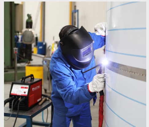
► Fonction Dynamics pour apport thermique constant et SPOT pour soudage temporisé.
