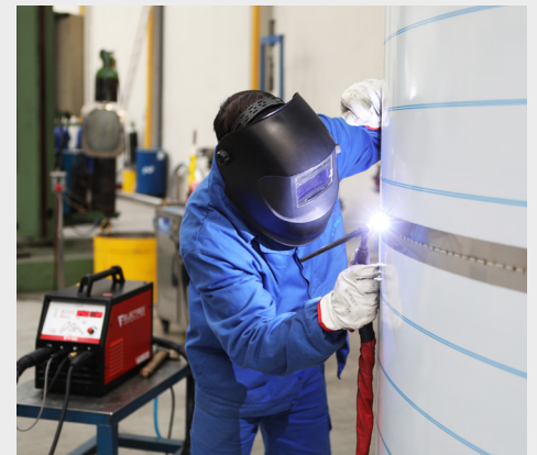
► Funcionalidad Dynamics para entrega térmica constante y SPOT para soldadura temporizada.
