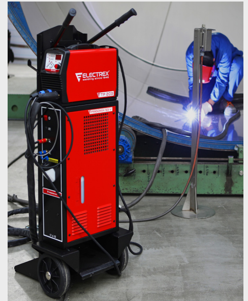
► Carro de transporte para los modelos TP 163 y TP 203, para facilitar el desplazamiento, con o sin refrigerador y botella de gas.
