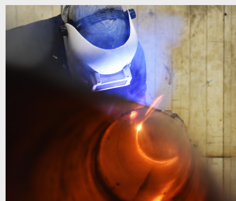
► Ajuste electrónico de la inductancia para llenar o penetrar.
