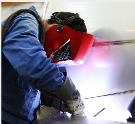
► Soldadura TIG con cebado del arco por alta frecuencia con su rectificador.
