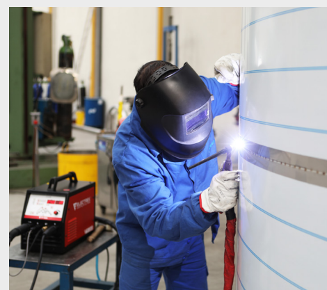
► Funcionalidad Dynamics para entrega térmica constante y SPOT para soldadura temporizada.
